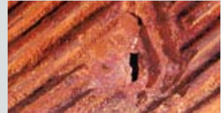
İÇTİP OYULMA Suda aşırı miktarda agresif element bulunduğunda ortaya çıkar.
