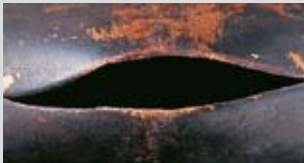
DONMA KIRILMASI Evaporatörde düşük miktarda su akışından kaynaklanır.
