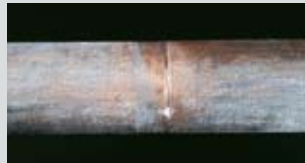
BORU DESTEK AŞINMASI Boru/destek temasından kaynaklanır. Bu duruma çok nadir rastlanıyor olsa da hemen tespit edilmelidir.
