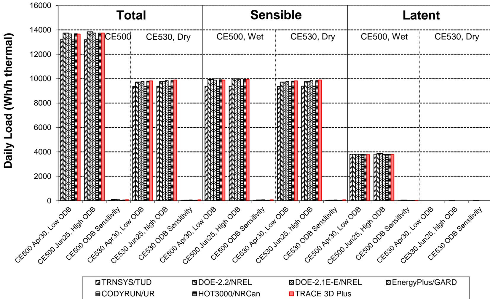
**Figure B16.5.2-44. HVAC BESTEST: f(ODB) for CE500, CE530
