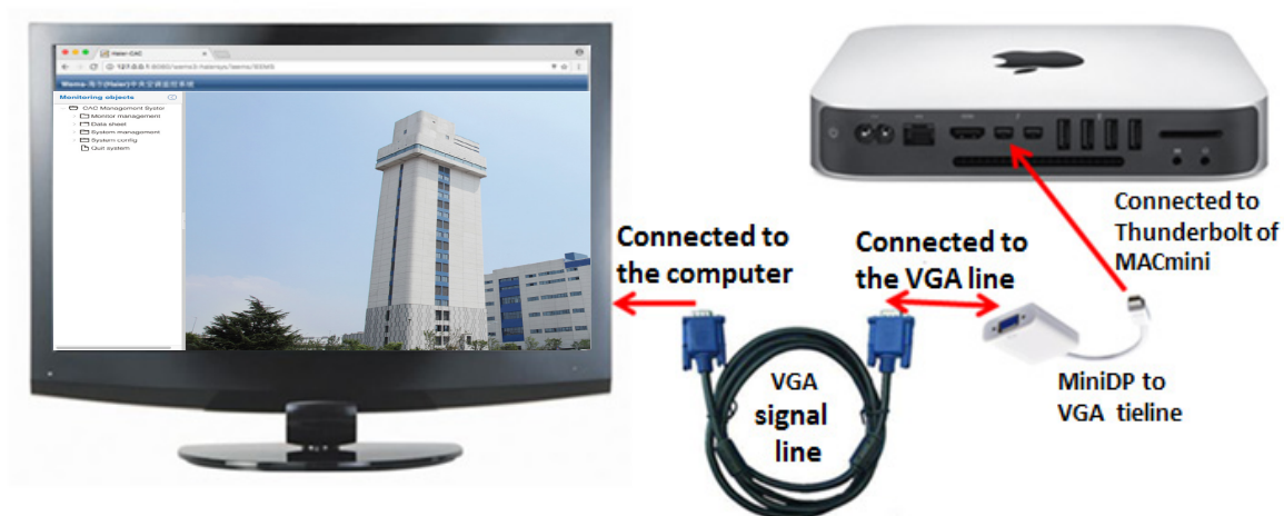
Diagrama de conexión de Mac Mini y pantalla
