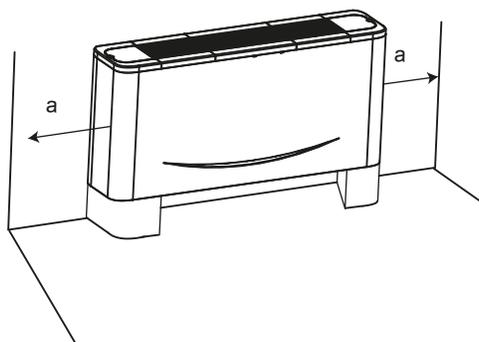
Figura 2 Base do ar de retorno sem tampa
