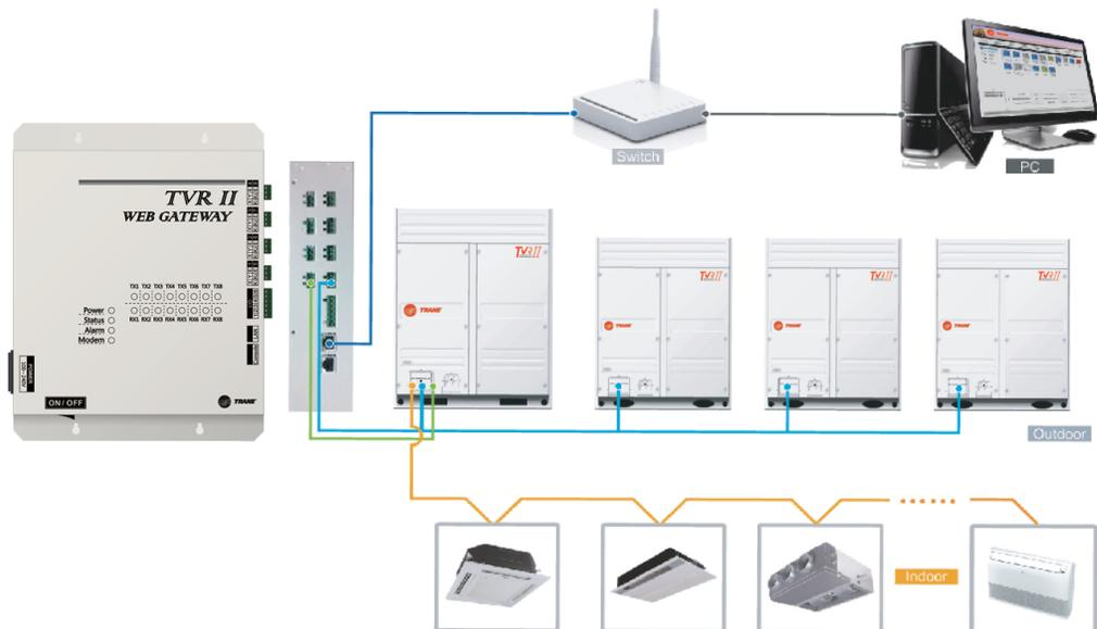
La caja de acceso TVR II se utiliza como medio de comunicación y para el control de la unidad interior. La caja transmite información de estado de la unidad interior a la computadora. Asimismo transmite las órdenes de control y de supervisión, enviadas por la computadora, hacia la unidad interior.
