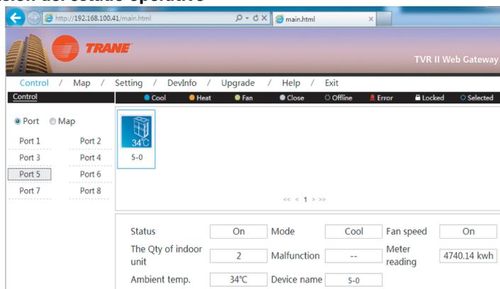
Seleccione las terminales 5-8; se desplegará la unidad. Luego pulse el icono de una unidad exterior y se desplegará su estado operativo que incluirá el estado ON/OFF, modo operativo, estado del ventilador, cantidad de unidades interiores, protección contra error, lecturas de amperaje, etc.
