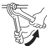
Conecte a tubulação da unidade interior utilizando duas chaves e aplicando o torque de aperto mostrado na seguinte tabela:
