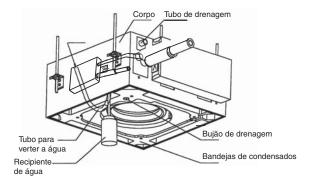
3. Ligue a unidade à energia e opere em modo de esfriamento. Verifique se o som do motor da bomba de drenagem é normal e, se a água sai apropriadamente. Verifique se não há vazamentos.
