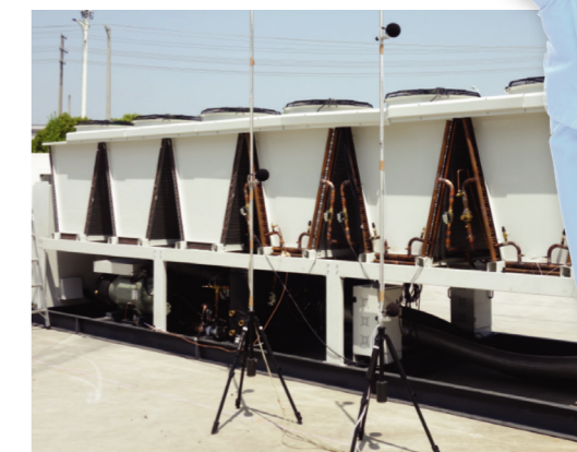
Testes de potência sonora confirmaram que o RTAG atende aos requisitos da ISO 3744.
