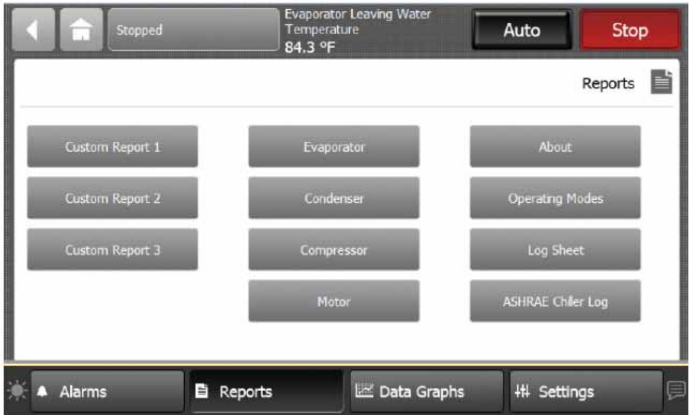
Ilustración 3: Informe de la interfaz del operador de la pantalla TD7
