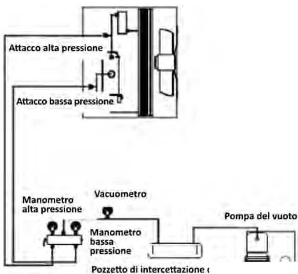
Schema del circuito di raffreddamento con attacco alla pompa del vuoto
