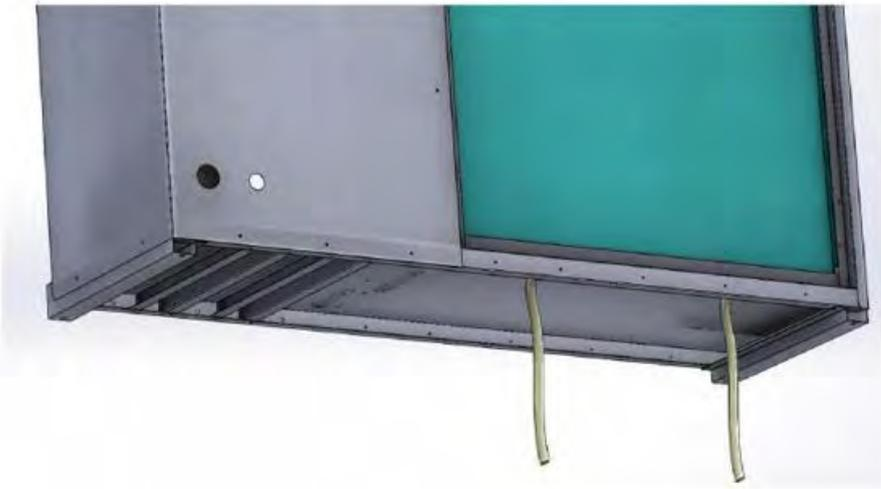
**C. Posizionare l'unità nel gruppo con il serbatoio, allineando i fori della staffa superiore del serbatoio con i fori praticati nel lato inferiore del piede, accertandosi di dirigere i tubi di scarico all'interno dei fori, alla base del kit idronico.**
