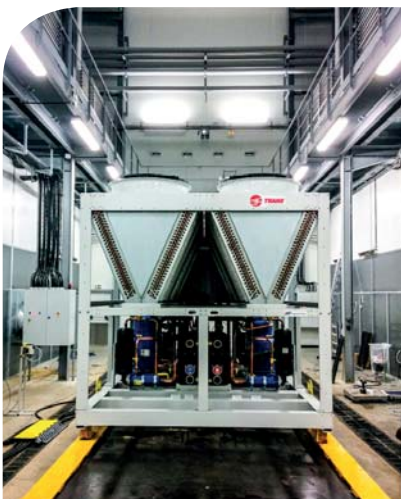
Unidade CMAC HE no sistema de ensaio do nosso laboratório em Charnes (F)
