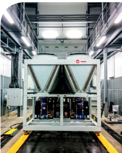
Circuito de prueba de la unidad CMAC HE en nuestro laboratorio de Charmes (Francia)
