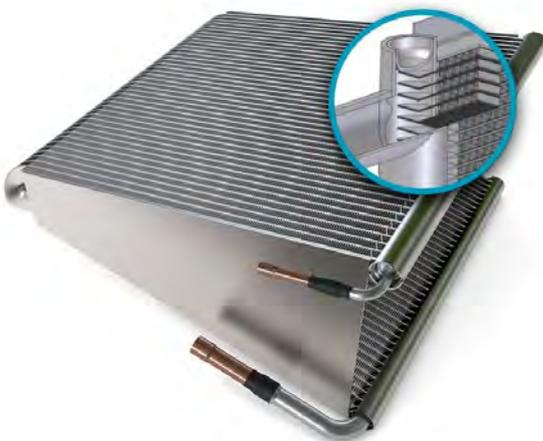
Luftgekühlte Mikrokanal-Verflüssigerregister mit Aluminiumlamellen. Das Register besteht aus drei Komponenten: den Mehrkanalrohren, den Lamellen zwischen den Mikrokanälen und den zwei Kältemittelverteilern.
