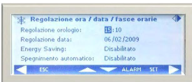
Die Ausschaltung des Gerätes kann auf Basis von Zeitbändern erfolgen. Auch eine innovative Energiespar-Funktion kann zur Ein- und Ausschaltung des Geräts genutzt werden. Bei Aktivierung dieser Funktion passt der Regler bei bestimmten Zeitbändern den Sollwert auf den Benutzer an.
