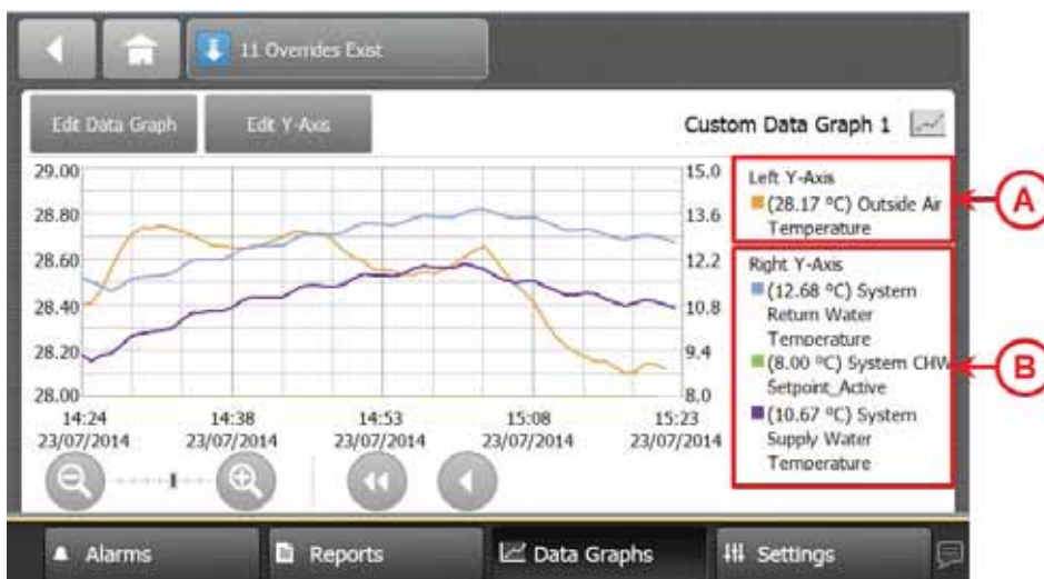
Abb. 8: Diagramm „Operating Temperatures“ (Betriebstemperaturen)
