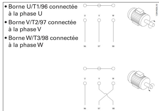
Un contrôle de la rotation du moteur peut être fait au moyen d'un Contrôle de rotation du moteur 1-28 et en suivant les étapes indiquées sur l'écran.
