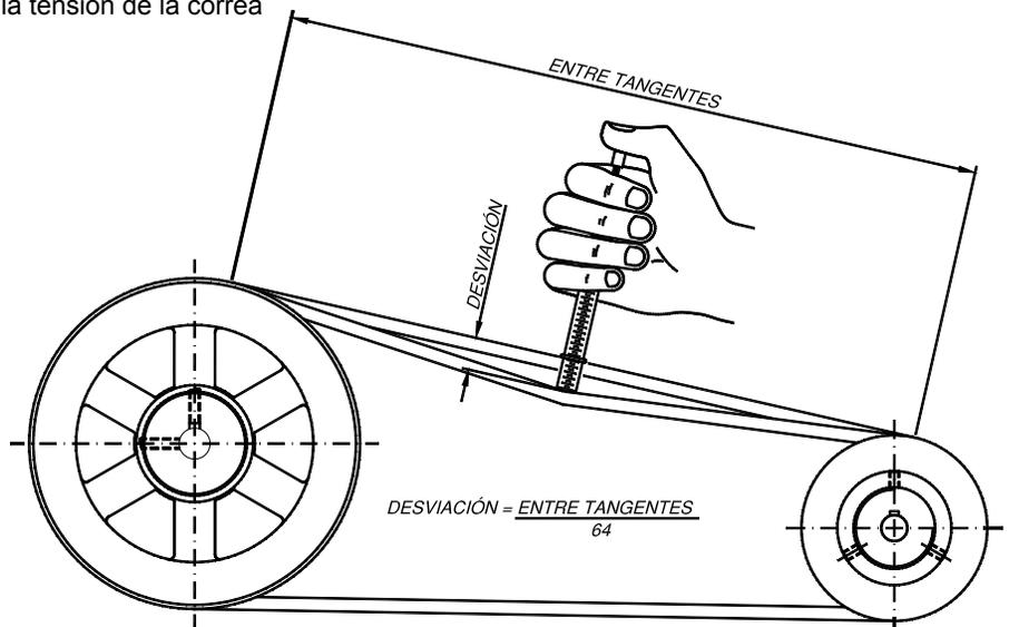
Fig. 07 - Medidor de tensión de la correa
