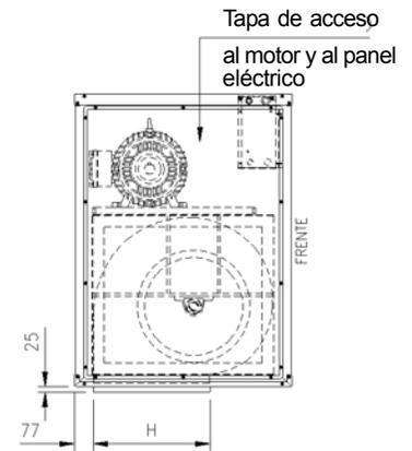
Fig. 41 – Dimensiones del módulo de serpentín 350 a 500
