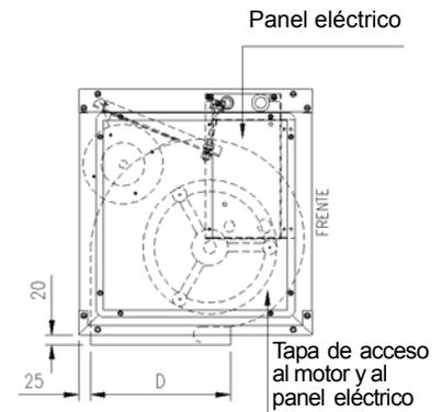
Fig. 32 – Dimensiones del módulo de serpentín 050 a 100
