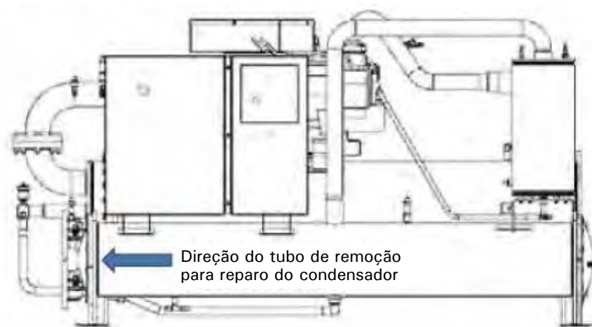
Figura 75. Trocando o tubo do condensador
