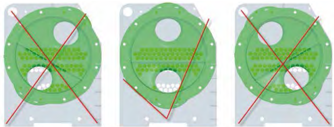
Figura 16. Tampa de água do condensador do RTHE
