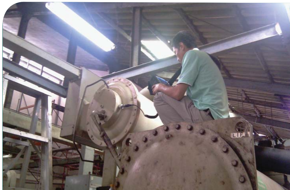
แสดงขั้นตอนการตรวจวัดการสั่นสะเทือนถึง 3 แนวแกน
