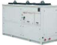
Spiralverdichter, Axialventilatoren Modelle nur für Kühlbetrieb oder Wärmepumpen Integrierte Pumpen-Einheit CGAN/CXAN 45-465 kW
