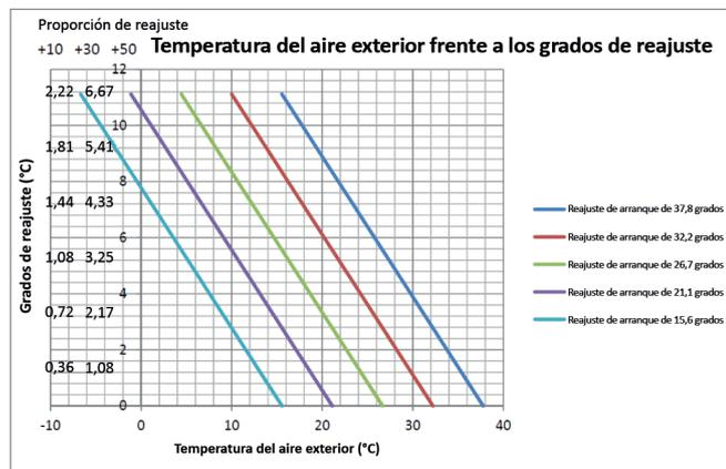
Ejemplo del cálculo del reajuste para la temperatura del aire exterior:
