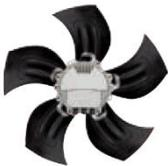
Les **ventilateurs** sans balais à commutation électronique assurent un meilleur rendement comparé aux moteurs traditionnels à courant alternatif grâce à une consommation d'énergie plus faible. Les moteurs à commutation électronique permettent par conséquent une réduction des émissions sonores au cours de la modulation du débit d'air.
