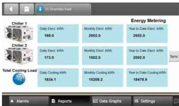
**EnerView** di Trane misura il consumo di energia di ogni refrigeratore e calcola la capacità di raffreddamento prodotta dall'impianto. Un pannello di controllo sullo schermo mostra il consumo giornaliero e la capacità di raffreddamento settimanale e annuale.
