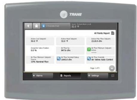
Das Tracer™ TD7-Display verfügt über einen Touchscreen mit Farbdarstellung für die einfache Betrachtung und Bearbeitung der Daten des Tracer UC600. Gebäudetechniker können problemlos die Raumtemperatur und relative Luftfeuchtigkeit überwachen, Sollwerte ändern und die Übersteuerung von Punkten mit Zeitbegrenzung eingeben – alles per einfacher Berührung des Displays.
