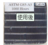
▲使用愛瑞室防腐蝕劑，1000小時鹽水測試後依然完整
