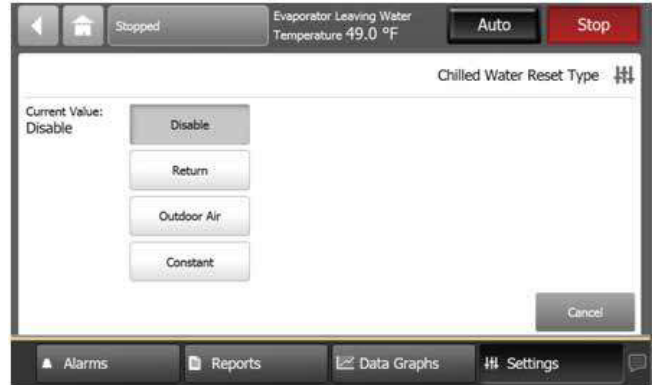
Figura 35. Pantalla de tipo de restablecimiento de agua refrigerada
