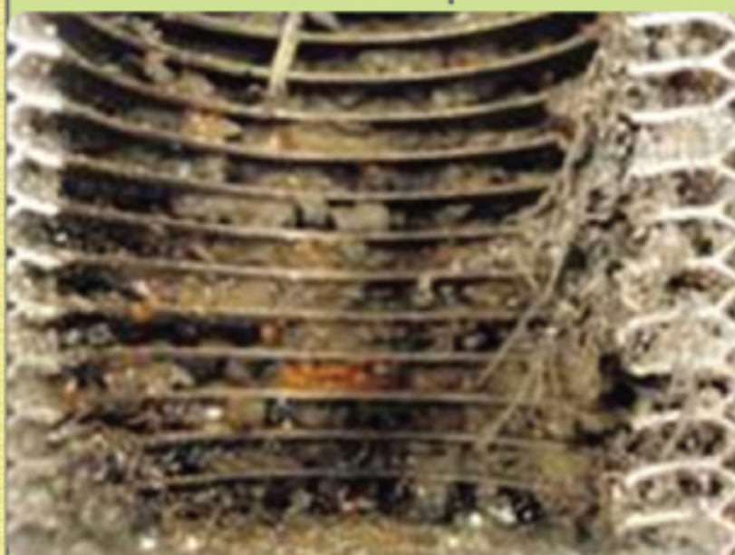
รูปถ่ายภายใน Plate Heat Exchanger ที่เกิดการ Freeze เนื่องจากการอุดตันของสิ่งสกปรก
